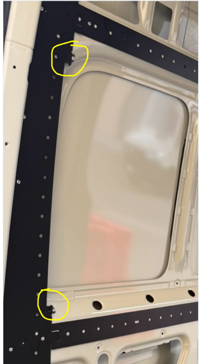
B — Tabs at this brace edge
